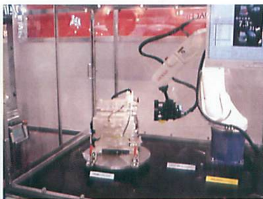
図4.2 ロボットとカメラを利用した外観検査例
