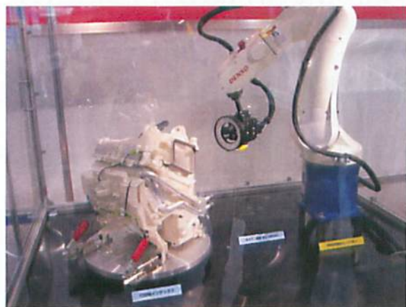
図4.1 ロボットとカメラを利用する外観視覚検査システム 2)
