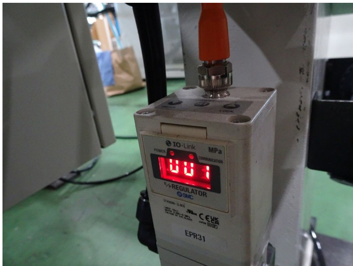
図 3：コントローラからの数値信号を受けて糊の量を制御する電空レギュレータ （出所）ニューロン工業喜多方工場の了解を得て筆者撮影。
