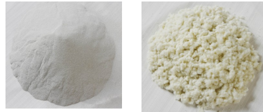
図8 再生塩ビコンパウンド(左)、再生パルプ(右)
