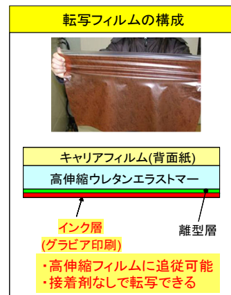
図2 高伸縮転写フィルムの構成
