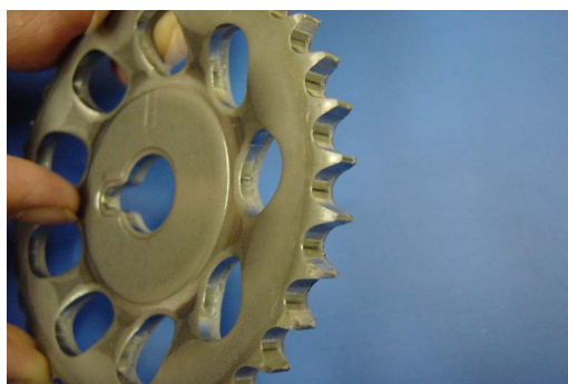
写真2 自動車エンジン用スプロケット加工例
