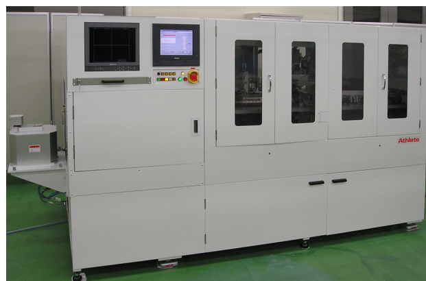
図3 全自動ボールマウンタの外観
