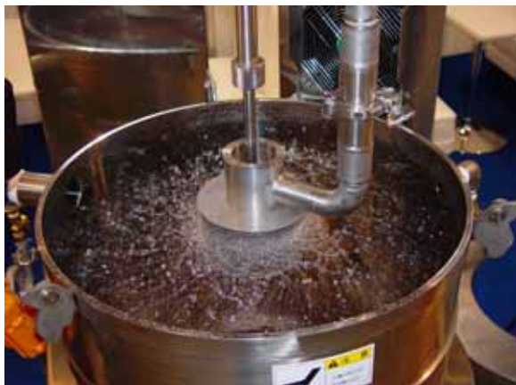
図5 糖蜜が網カゴから飛散する様子
