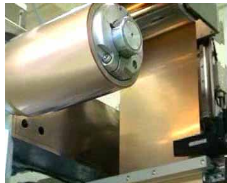
図2 フレキシブル基板の送り(Roll to Roll)
