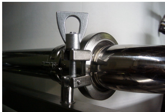
図2 クランプ式の接続状態
