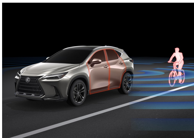
図2 安心降車アシストシステムイメージ
