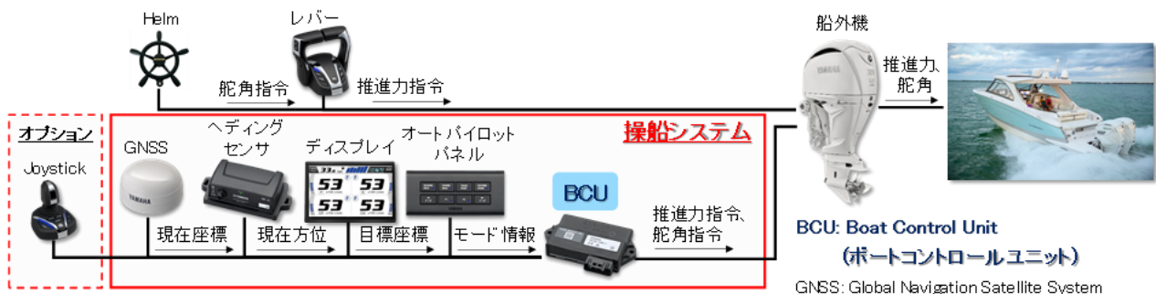
図2 開発した操船システムを備えたボートの一般的な構成
