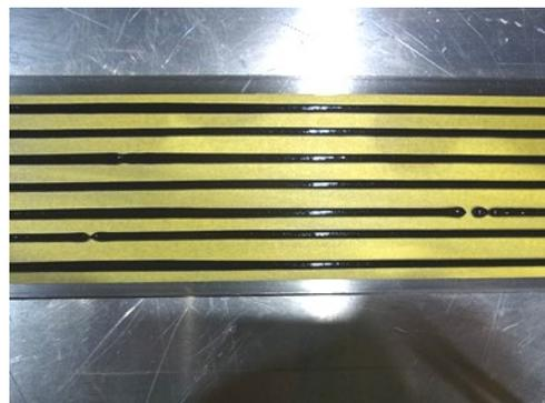
図6 直径2mmの塗布線
