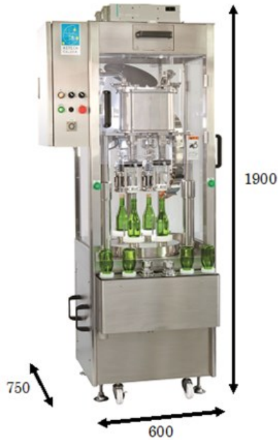
図2 安価コンパクトな少量多品種型 飲料充填機(2019年開発)
