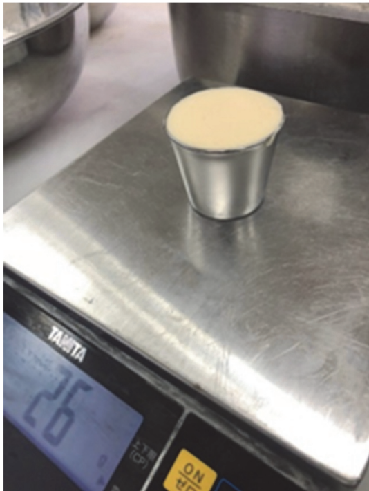
図1 テスターカップを使用した比重の計測方法
