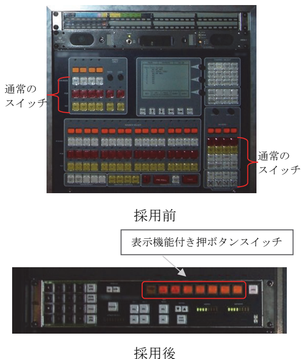
図1 表示機能付き押ボタンスイッチによる機器の省スペース化
