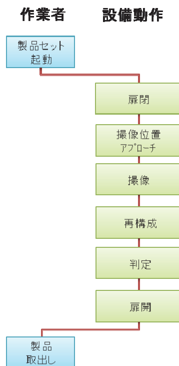
図5 作業、設備動作フロー
