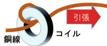
図3 従来の引張巻き取り方式
