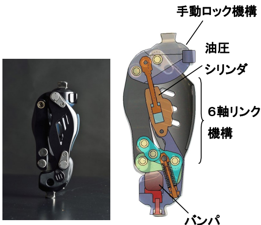
図3 開発した義足膝継手の外観および構成
