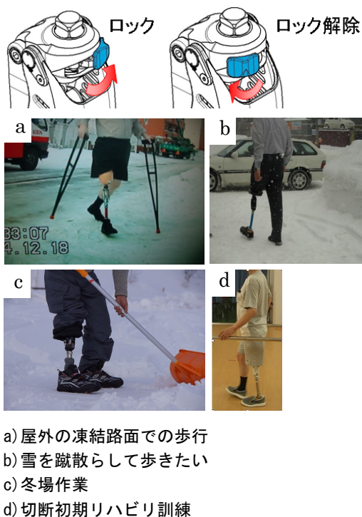
図8 手動ロック機構および使用例
