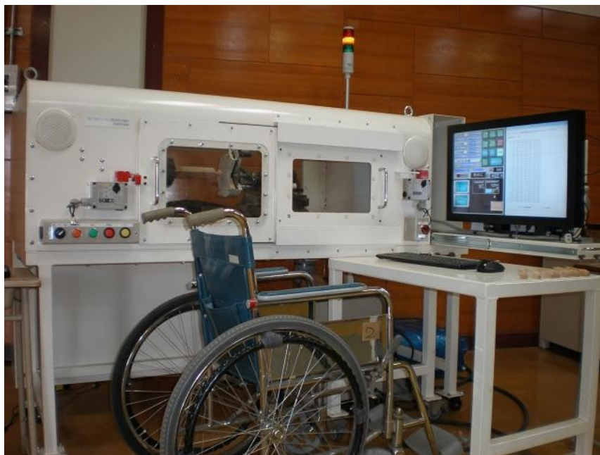
図3 操作フローと開発したCNC木工旋盤
