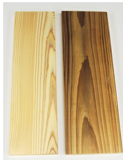
図4 ロールプレスと平板型加熱圧縮プレスとの比較
