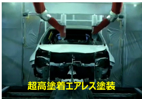
図9 量産ラインでの実車塗装(弊社堤工場) (上:従来塗装、下:超高塗着エアレス塗装)
