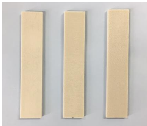
図3.8 造形された試験片の例 (ZP131)
