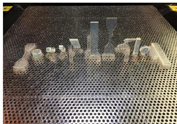
図3.1 光造形試験片(TSR-883)作成の様子
