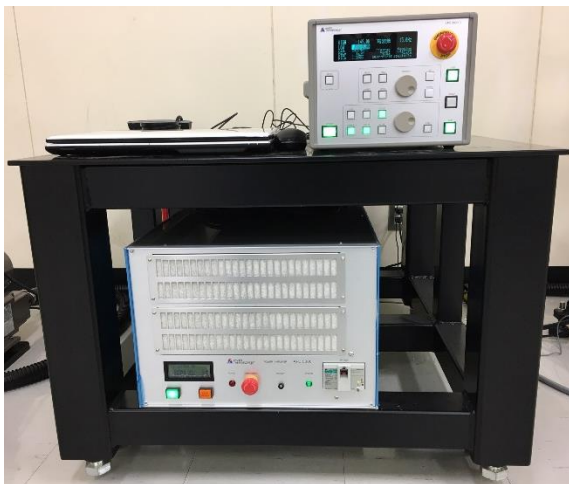
図 3.25 疲労耐久試験機（試験制御部）
