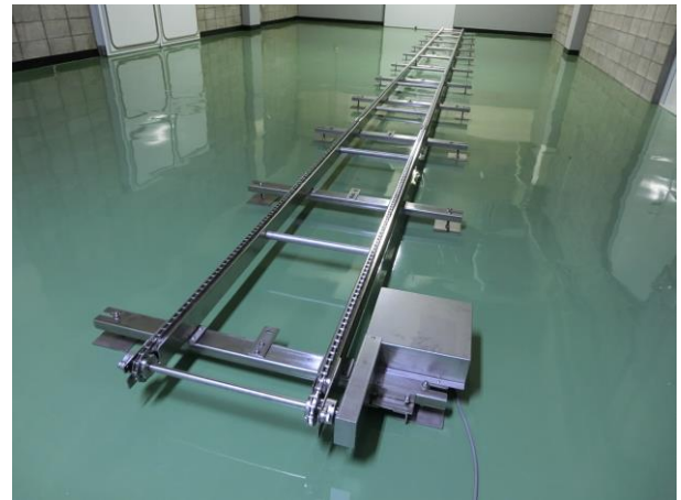
図 4.20 チェーンコンベアの基本構造
