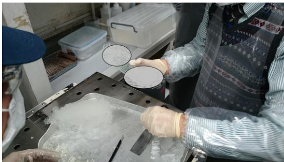
図 5.5.5 土台，サポート除去（光造形方式） （1月30日）
