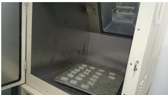
図 5.5.7 UV 硬化（光造形方式） （1月30日）
