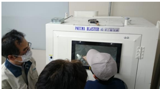
図 5.5.3 エアブローによる後処理 (樹脂粉末焼結方式) (12月18日)
