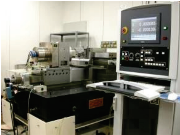
超精密旋盤UPL-200 (加工精度約数十nm)
