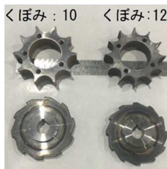
図8 既存串団子製造機で使用した成形ロール(上)とラチェットギア(下)
