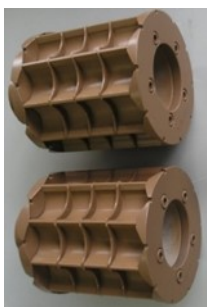
図4 成形ロール写真、構造
