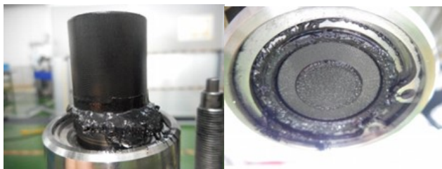
図7 25,000回接続・分離後の漏れ
