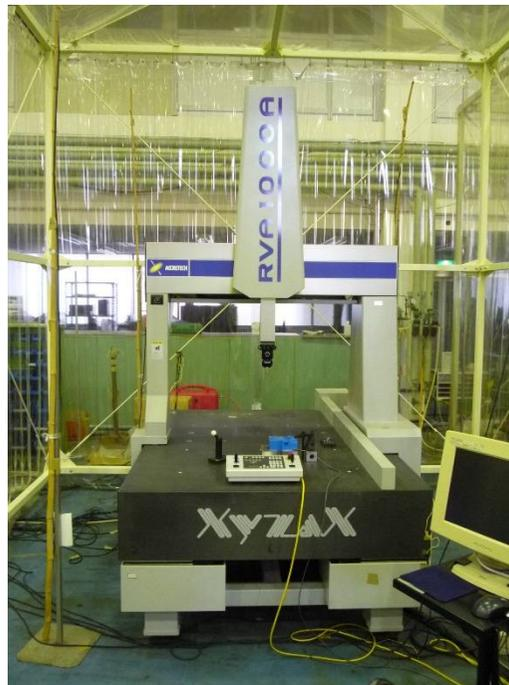
接触式3次元測定装置
