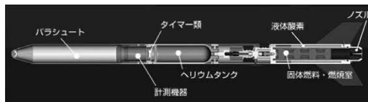
図表4 CAMUI型ハイブリッドロケット 打上げ実証試験機体の構成
