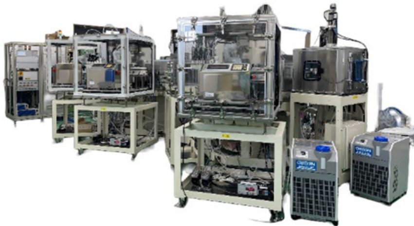
図6-7 産業技術総合研究所が開発した世界初の「ペロブスカイト太陽電池自動作製システム」 36
