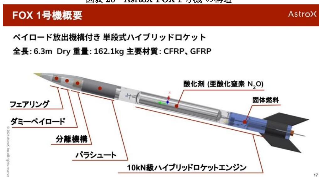
図表 20 AsrtoX“FOX 1 号機”の構造
