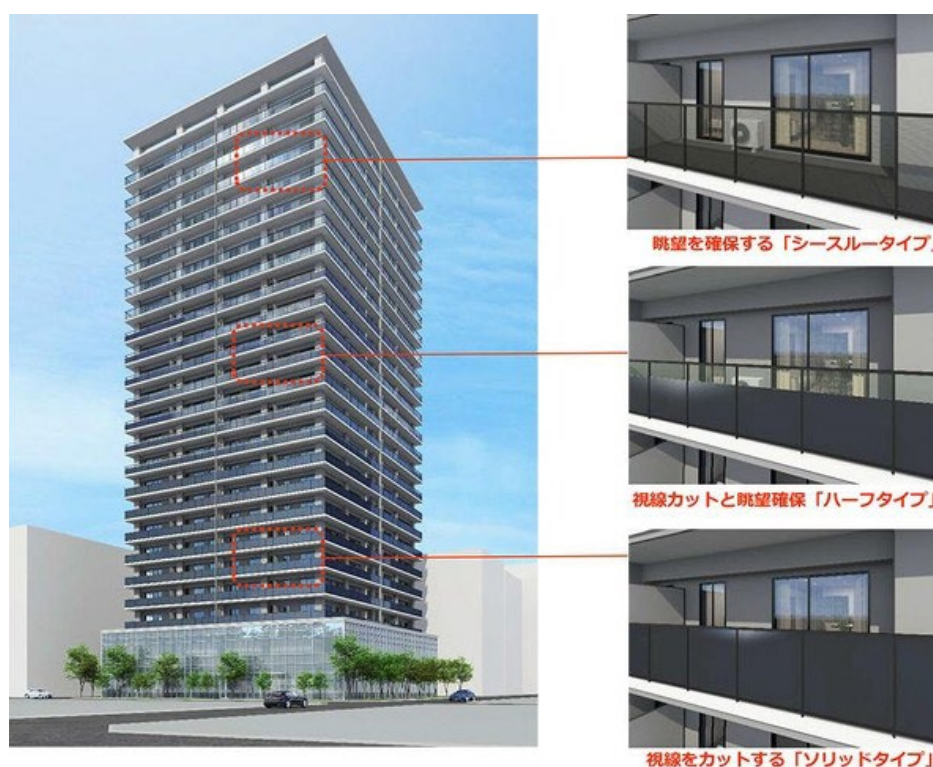
図 5-4 超高層マンションのバルコニーで発電する「ガラス手摺一体型太陽電池システム」の導入イメージ（出典：大成建設株式会社・株式会社カネカ、「バルコニー用「T-Green® Multi Solar」を開発」、2022 年 10 月 11 日） 50
