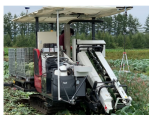
キャベツ自動収穫機 ©立命館大学・オサダ農機(露地野菜生産ロボット化コンソーシアム)
