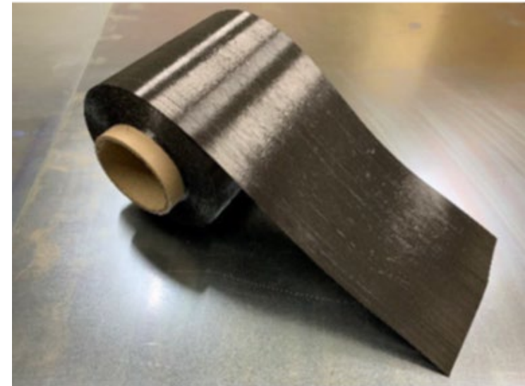
福井県工業技術センターが開発した開繊技術を用いて製造される炭素繊維複合材料 (CFRP) の薄層プリプレグシート
