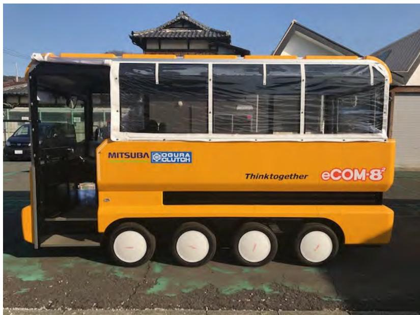
注) 写真車両は市内企業シンクトゥギャザー製「eCOM-8」の改良版である「eCOM-8<sup>2</sup>」。車椅子リフターが装着され（オプション）、営業車両化に伴い車室幅も広く設けられている。
