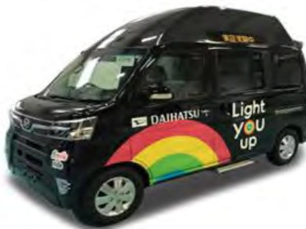
軽自動車を改造した普通車両（ワゴン車両）※自動運転機能なし
